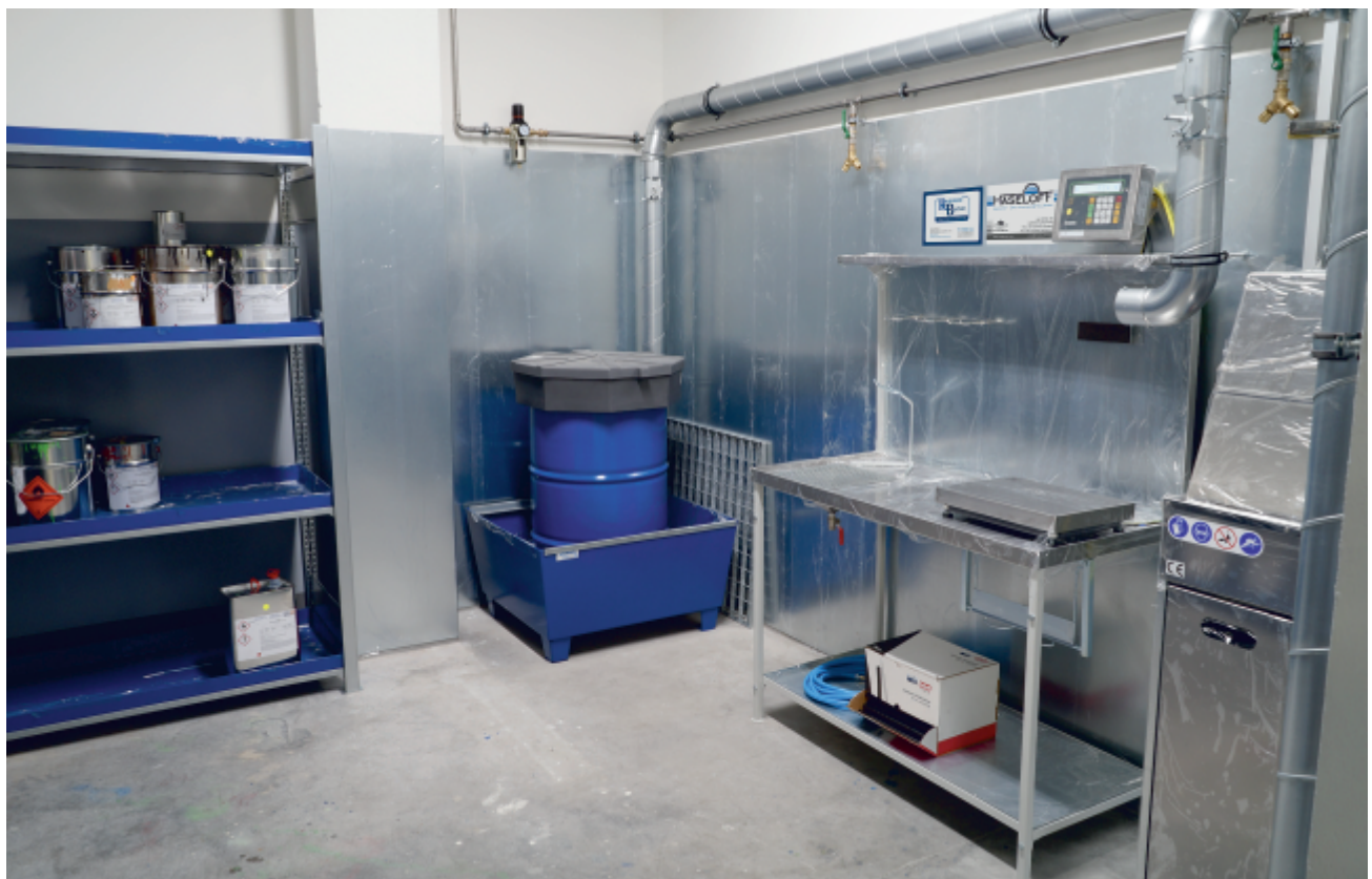
2K Versorgung im Container / Lacklager mit Anmischstation und Pistolenwaschgerät
